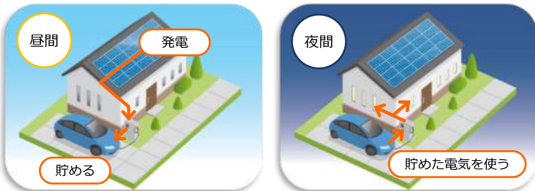
図 V2Hの仕組み
