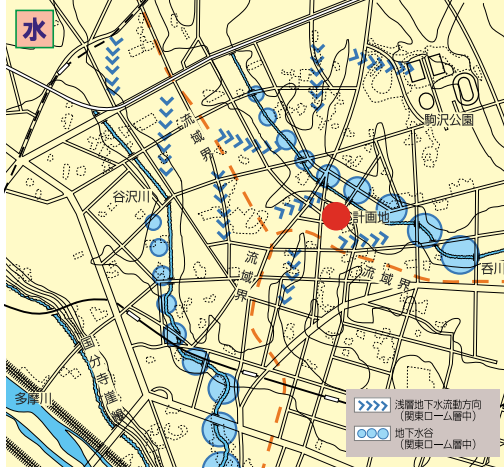
水の流れは、敷地が谷沢川流域の谷戸の斜面にあることから、図のように表流水や浅層地下水の動きを想定できます。そこで、土の地表面をできるだけ確保する、透水性の舗装を行う、雨水を貯溜し散水等に利用する、大規模な地下構造物をつくるのを回避することなどによって、敷地内での雨水浸透や一時貯溜を図り、水の循環を守ります。
