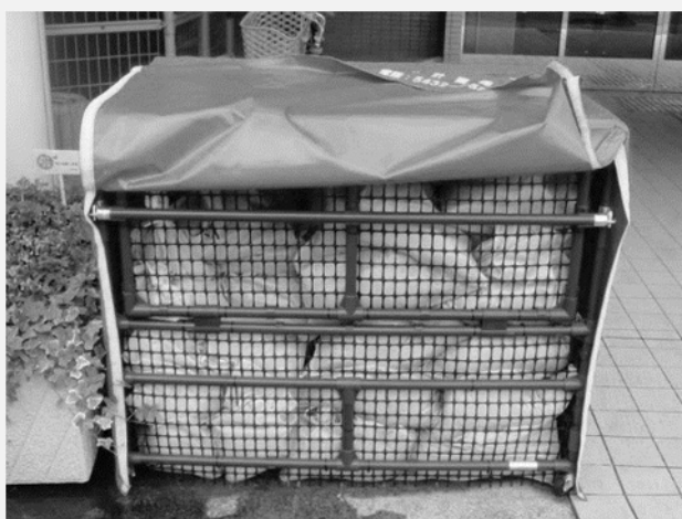
土のうステーションの例
