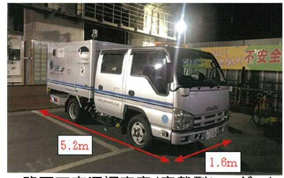
路面下空洞探査車(車載型レーダー)
