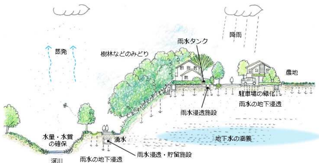
図 1.9 グリーンインフラによる水循環のイメージ(出典:世田谷区みどりの基本計画)
