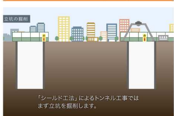
シールドトンネル工事の手順 2
