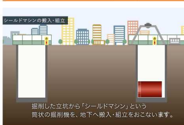
シールドトンネル工事の手順 3
