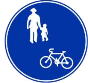
図 38 「普通自転車歩道通行可」の標識
