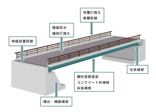
1 地覆打換え・高欄取替については、高欄の高さ不足解消が目的のため、補 修 2 回目では実施しない想定とした。
