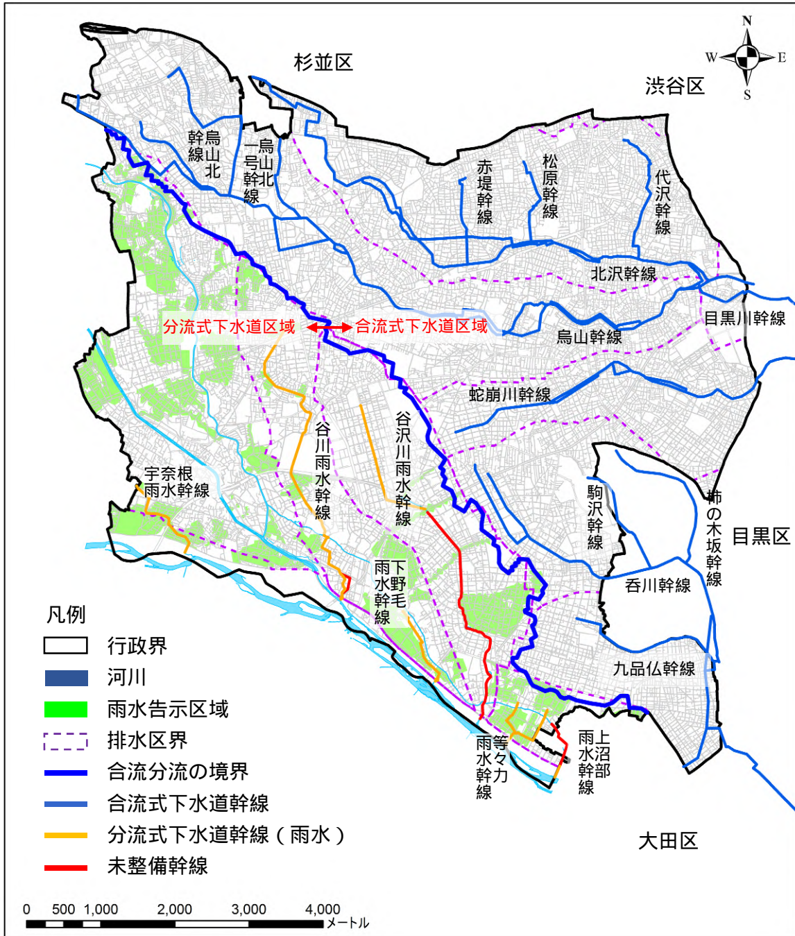
図2.2 下水道の整備状況図（平成28年7月現在）
