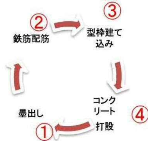
コンクリート打設サイクル
