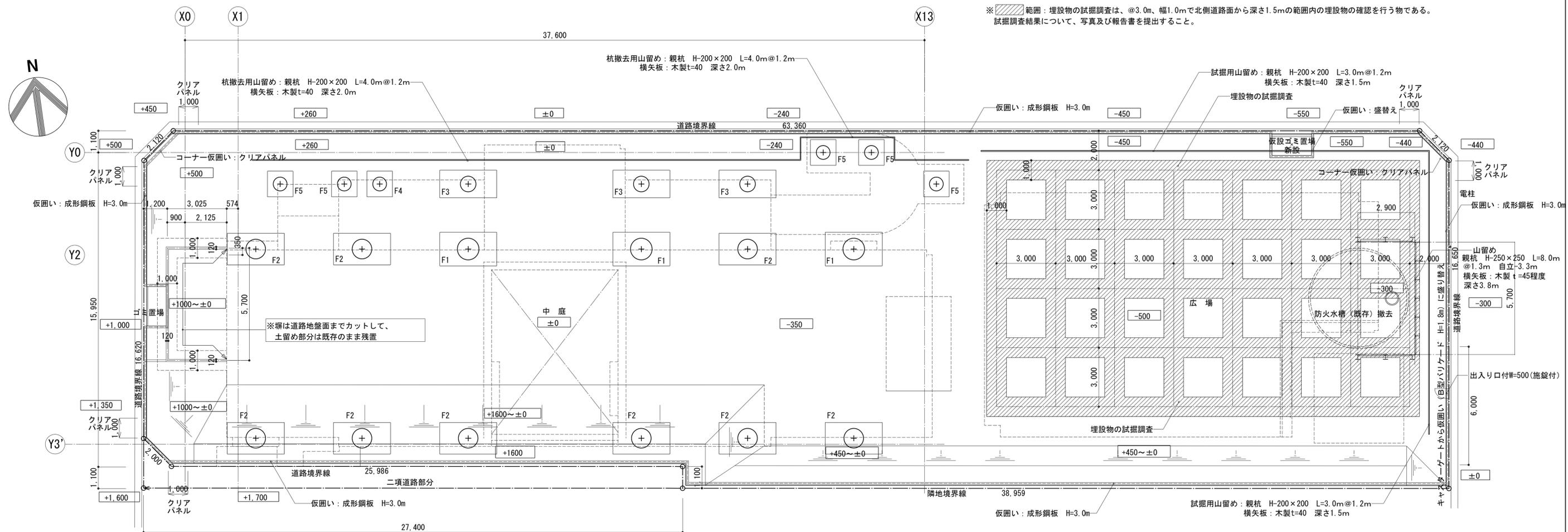
※ 埋設物の試掘調査は、@3.0m、幅1.0mで北側道路面から深さ1.5mの範囲内の埋設物の確認を行う物である。試掘調査結果について、写真及び報告書を提出すること。
