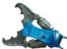
大割機 (コンクリートの建物 を壊すアタッチメント)
