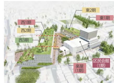
図6-1: 適切な工区分割によるローリング計画
