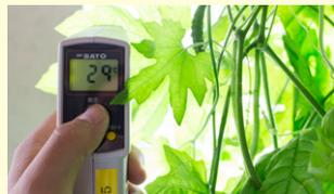
物体から放射される赤外線や可視光線の強度を測定して、物体の温度を測定する温度計。瞬時に、非接触で測定ができるため、暑いところ探しにピッタリの測定器具。安価なものから高額の器具まで様々ありますが、5000円～1万円前後の商品が一般的です。
