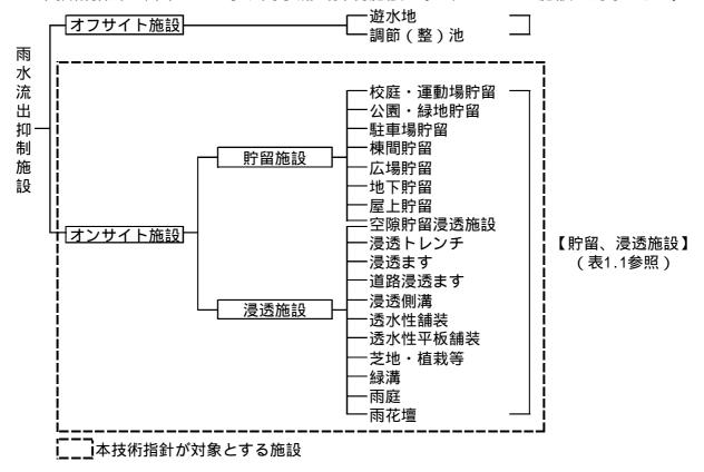
図 1.1 雨水流出抑制施設の分類
