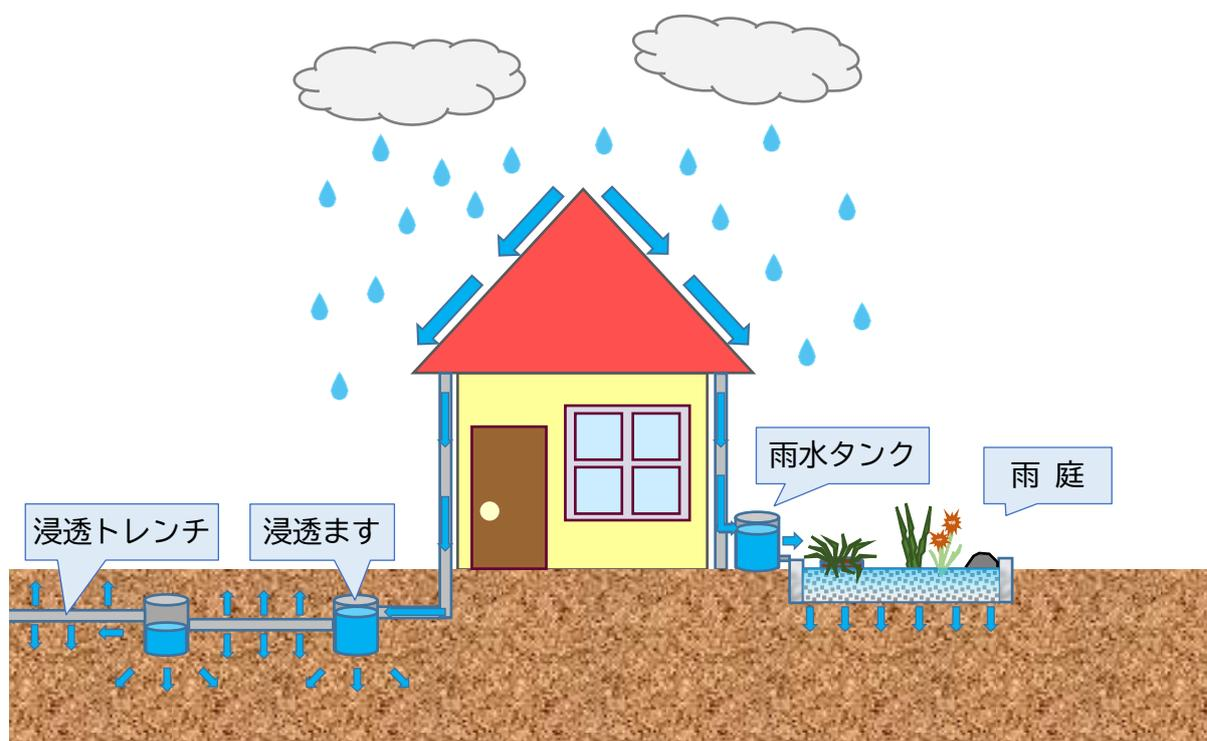
図 2.7 グリーンインフラ施設と降雨時の雨水の流れ
