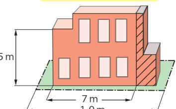
例えば、図のように環七に接する敷地の長さが10mの場合、長さ7mまでの建物部分は高さ5m以上としなければなりませんが、長さ7mを超える部分(図の斜線部分)についてはこの制限は適用されません。
