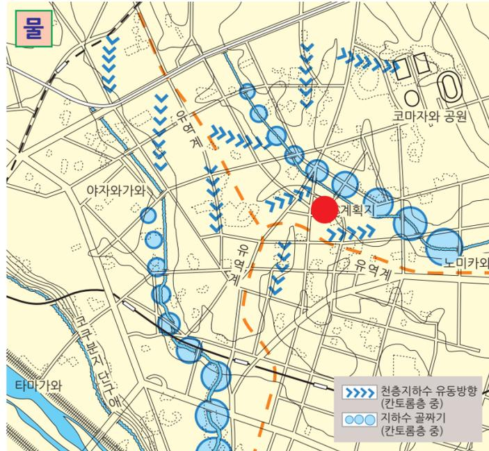
물의 흐름은 부지가 노미카와구역의 저지 사면에 있어서 그림과 같이 지표수나 천층지하수의 움직임을 상징하고 있습니다. 따라서, 흙의 지표면을 가능한 확보하고, 투수성 포장을 하고, 빗물을 저장하여 산수 등에 이용하는 대규모 지하구조물을 만드는 것을 회피하는 것 등에 의해 부지 내의 빗물침투나 일시저장을 도모하고 물의 순환을 지킵니다.
