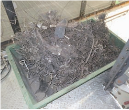
清掃工場の故障の原因となる金属片▶
