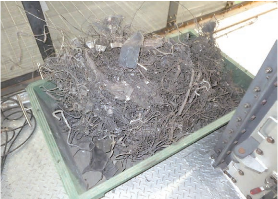
▲清掃工場の故障の原因となる金属片
