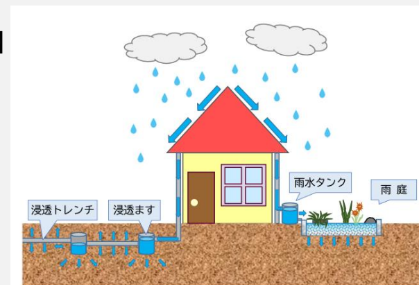
グリーンインフラ施設と降雨時の雨水の流れ
