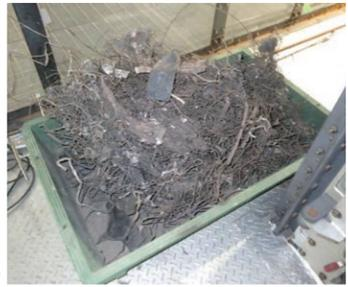
可燃ごみを焼却している清掃工場の停止の原因となった金属系ごみ
